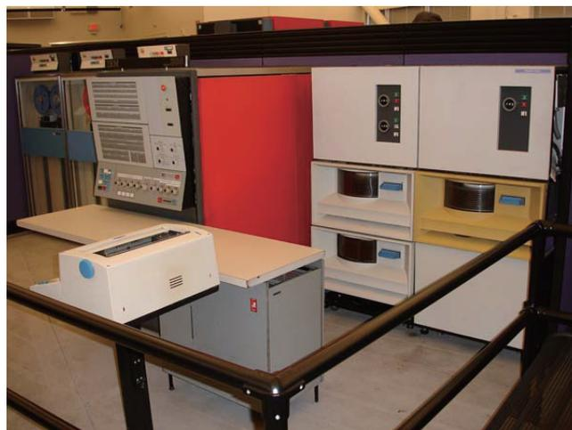
図 2.2: 大型コンピュータの例：IBM System/360 ( Wikipedia“System/360” から転載 )
