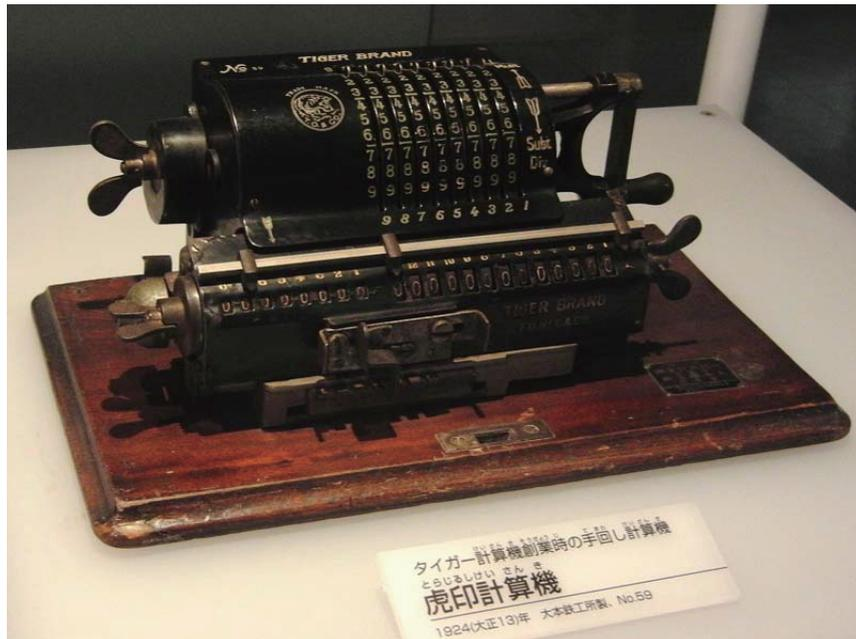
図 3.1: タイガー計算機 (Wikipedia“機械的計算機 ”から転載)
